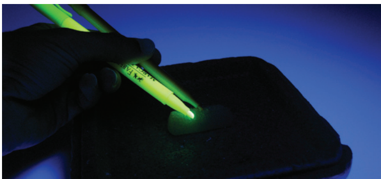
Canetas iluminadas com luz ultravioleta e mantidas em contato com uma pedra de gelo seco (-78,5 °C).
